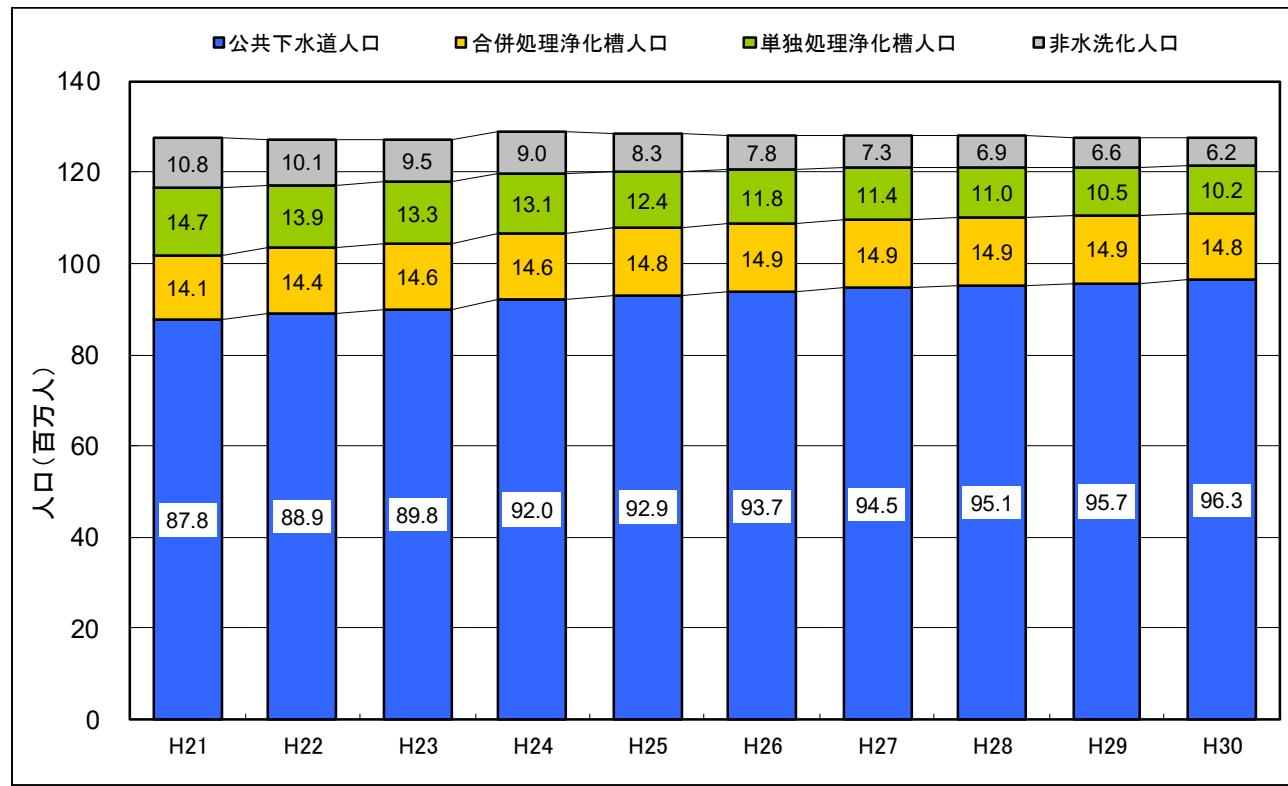
図－24 し尿処理形態の推移<sup>注22)</sup>
