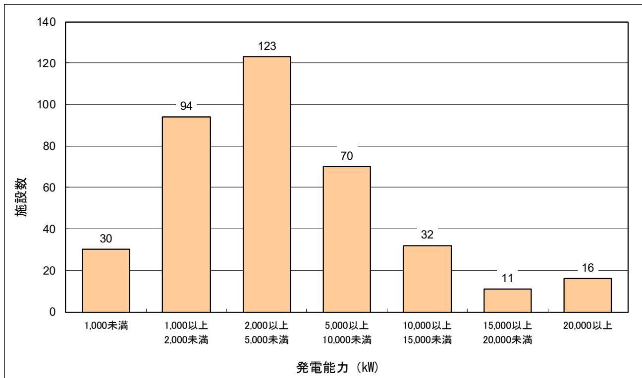
図－15 ゴミ焼却施設の発電能力別の施設数<sup>注16)</sup>
