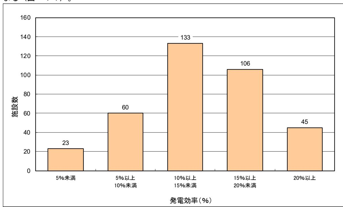
図－14 ごみ焼却施設の発電効率別の施設数<sup>注14)</sup>
