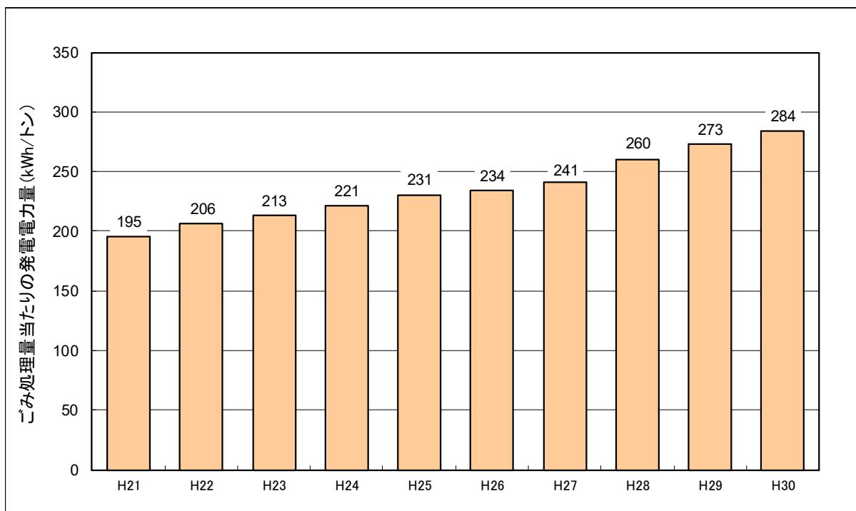
図－13 ごみ処理量当たりの発電電力量<sup>注13)</sup>
