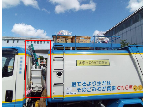
写真 2.3.1 パッカー車に専用の収納箱を設置し区分した例
