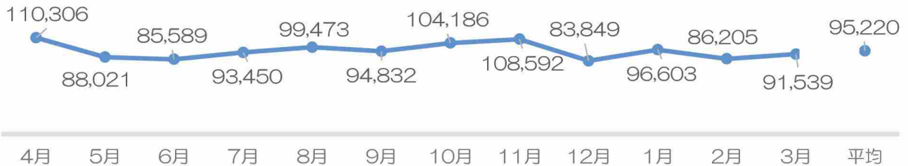
平成26年度の水処理施設の電力使用量 (kWh)
