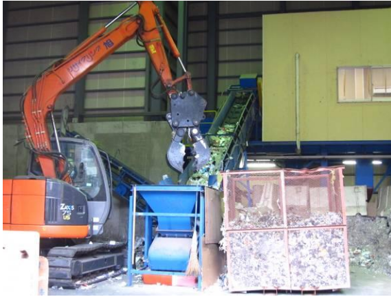
廃プラスチック類投入状況
