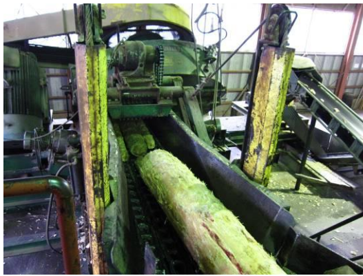
丸太投入状況
