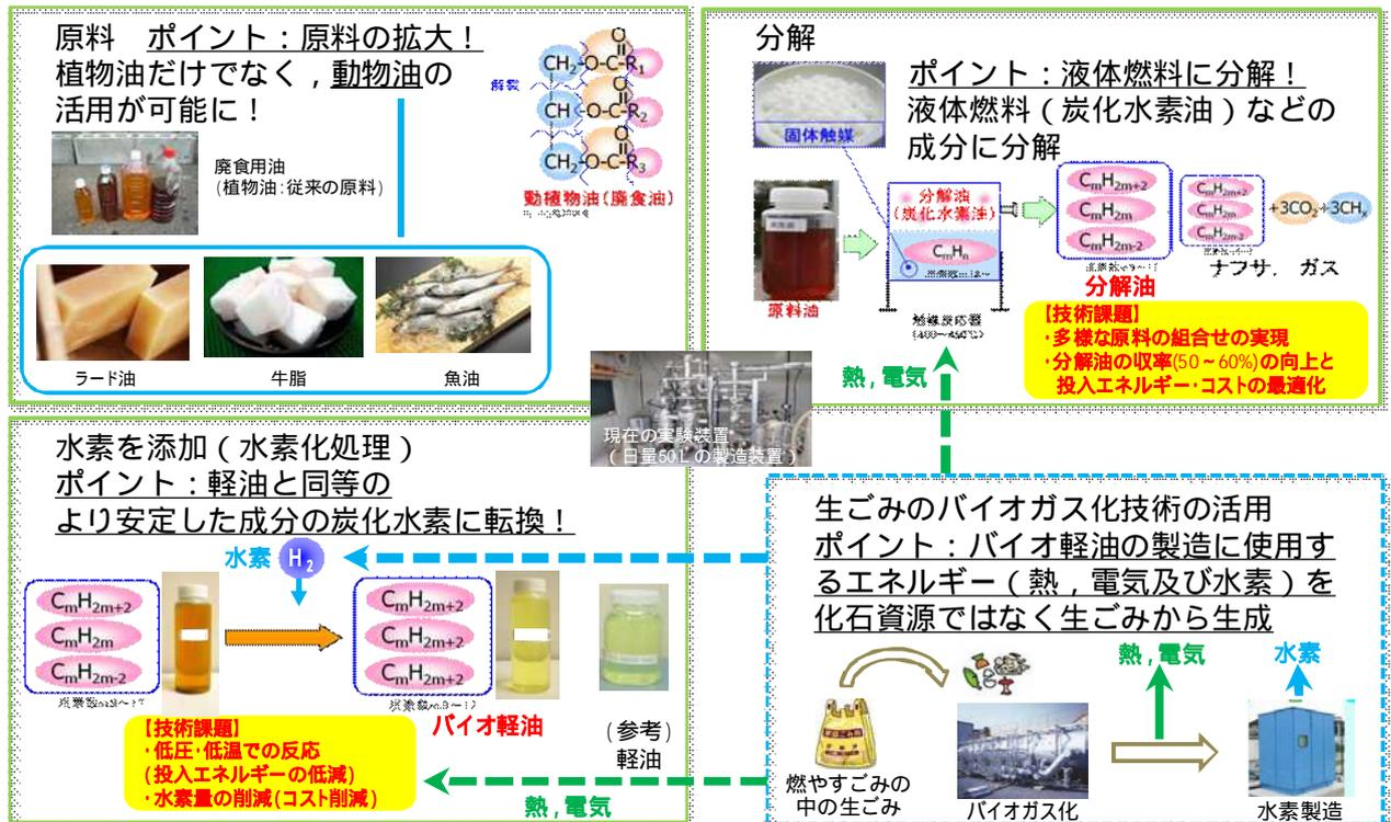
図 3-5 車両適正のある第二世代バイオディーゼル燃料利活用に向けた技術実証研究におけるバイオガス化とのコンバインドシステムの検討概要
