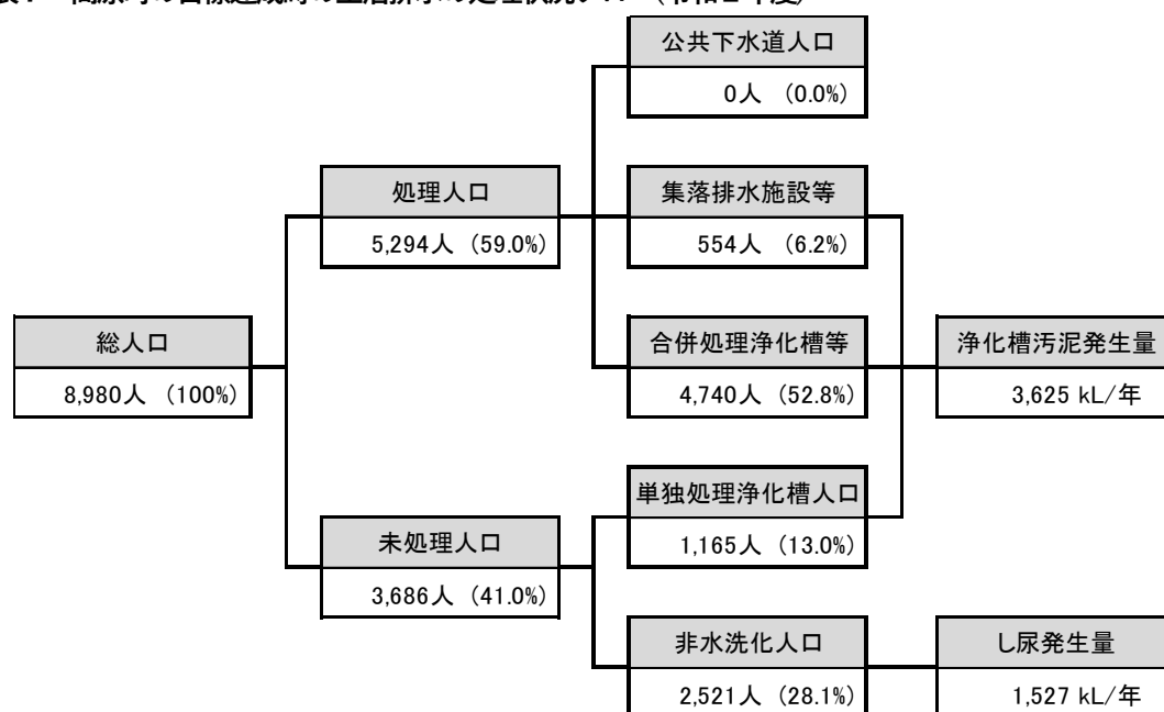
◆図表 7 高原町の目標達成時の生活排水の処理状況フロー(令和2年度)
