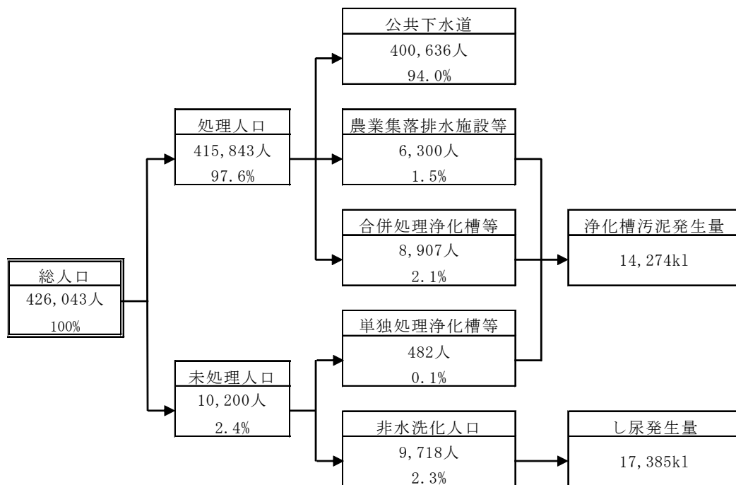
図4 7ヶ年計画における目標達成時の生活排水の処理状況フロー
