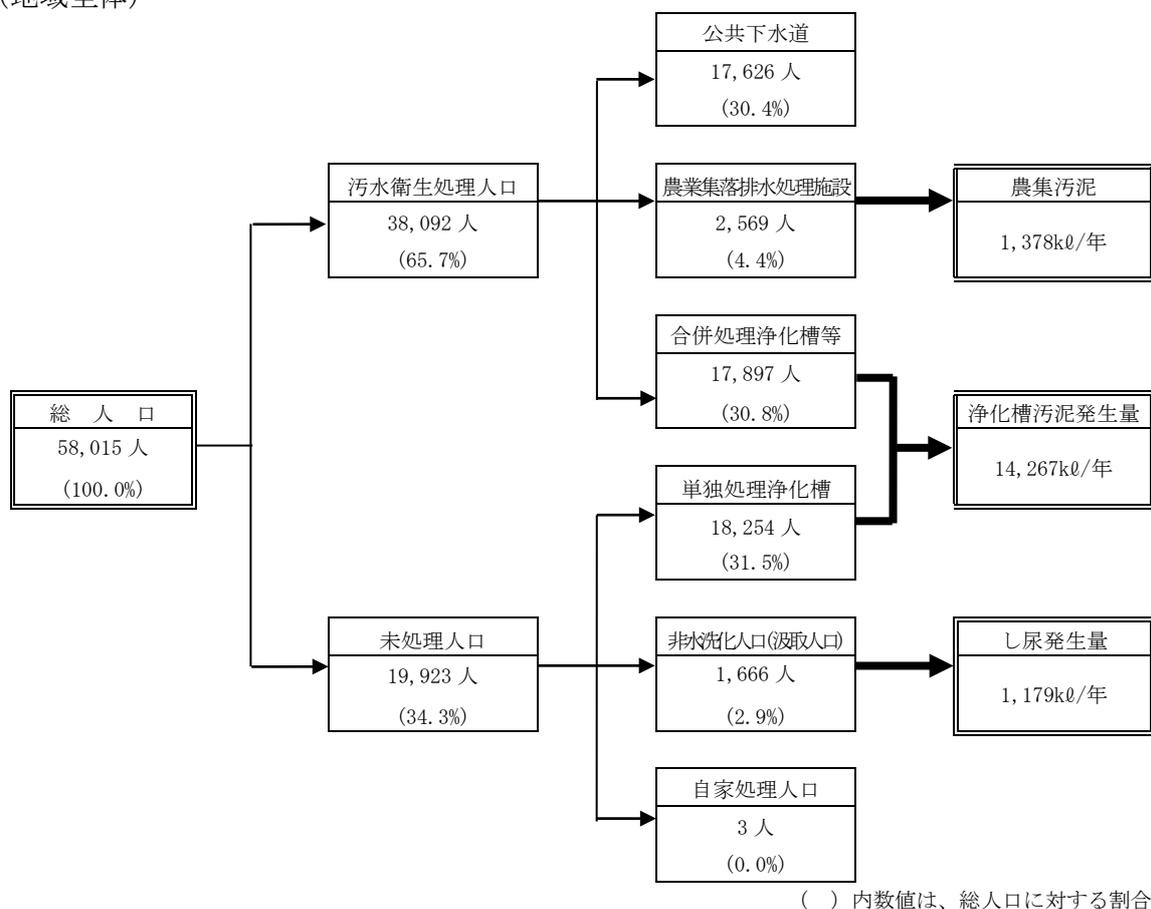
図4-1 目標達成時の生活排水の処理状況フロー (令和6年度)
