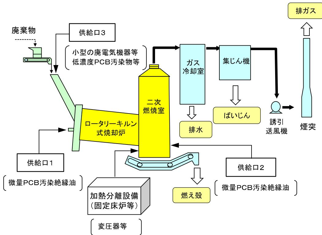
図2. 1 低濃度P C B廃棄物の焼却実証試験に
