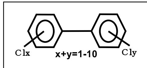
図1.1 PCBの構造
