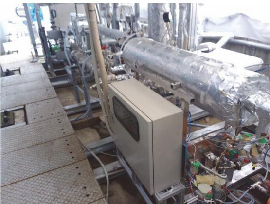
図 2-3-4 CO<sub>2</sub>分離膜装置
