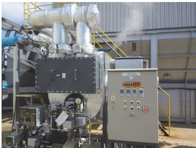
図 4-1-9 熱風発生炉型 NOx 発生装置外観
