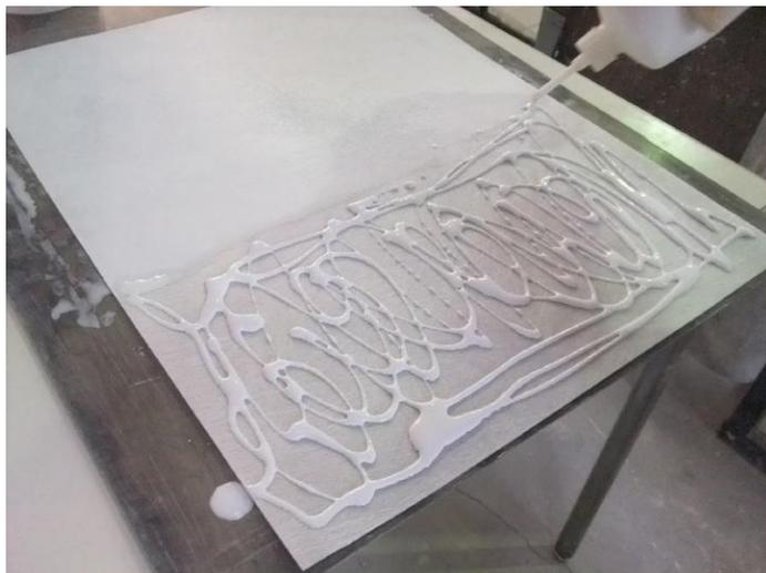
図 2-10 触媒スラリーをガラス繊維ペーパーに塗布した状況
