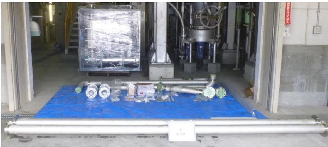
図 2-4 試験装置及び配管に使用した部品
