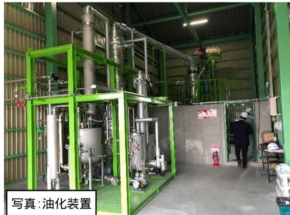
図 VII-4-3 プラスチックの選別及び油化施設の処理フロー図および選別ラインおよび油化装置の写真
