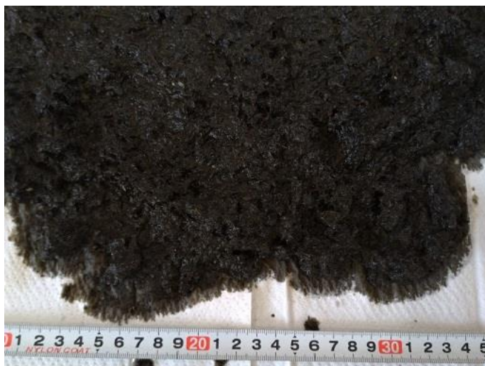
写真 2-3-20 側面引抜発酵残渣中の ≧約 2mm 画分
