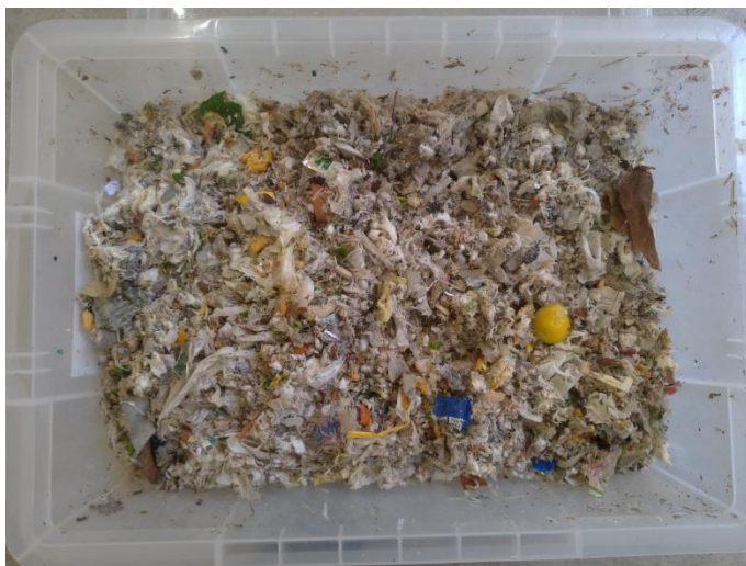
写真 2-3-16 E: 分別機の通過物 (発酵対象物)
