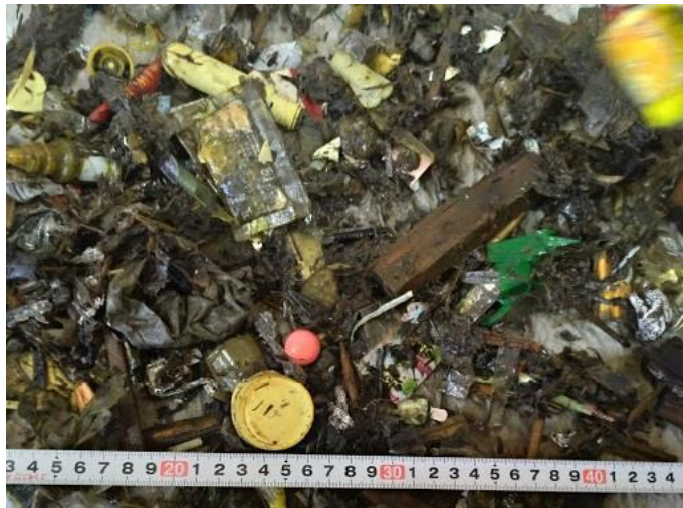
写真 2-3-19 側面引抜発酵残渣中の ≧約 10mm 画分
