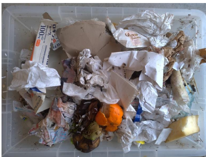
写真 2-3-13 B: 選別機の通過物 (→破碎分別機へ)
