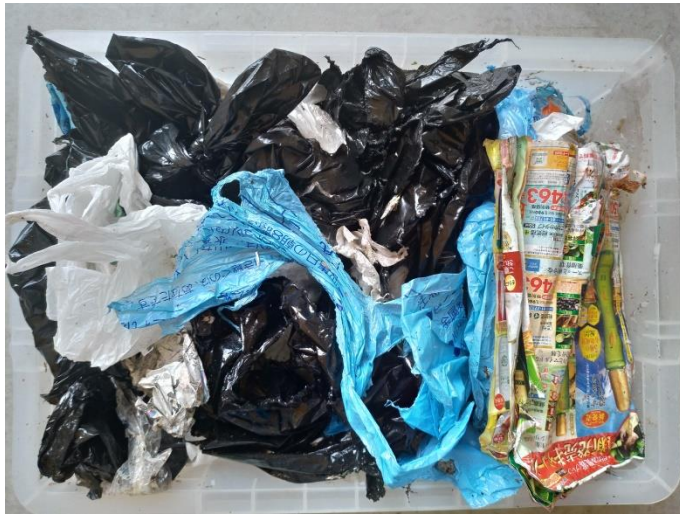
写真 2-3-14 C: 選別機の非通過物(上端側) (焼却対象物)
