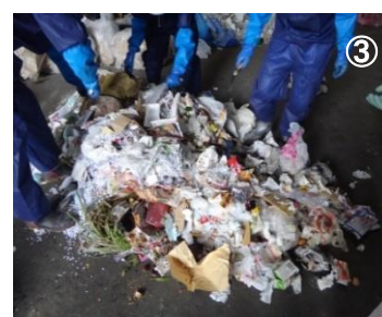
写真 2-2-1 可燃ごみの採取 ①ダンプイング ②パッカー車1台分のごみ ③無作為に袋を選び中身を出す ④縮分法で量を減らす ⑤分析用サンプル
