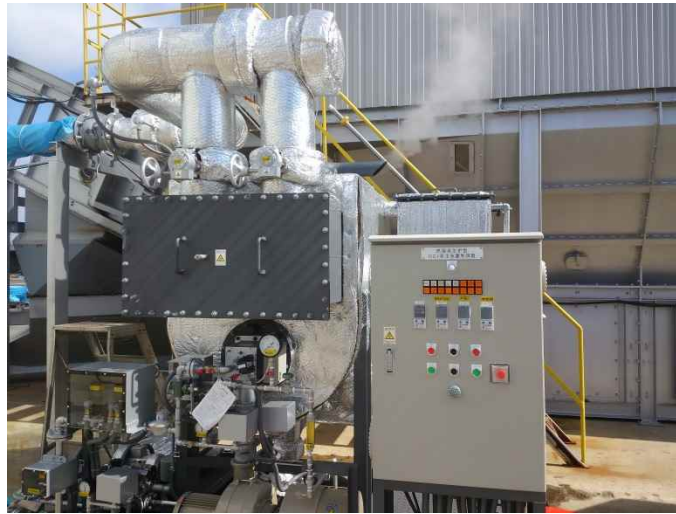
図 4-2-2 熱風発生炉型 NO x 発生装置外観
