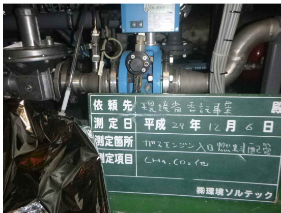
図 2-1-1 バイオガス分析試料採取状況
