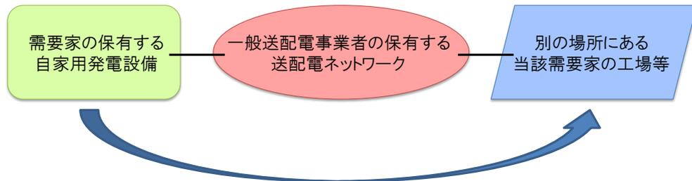
一般送配電事業者の保有する送配電ネットワークを利用して、自家用発電設備を用いて発電した電気を他地域の自社工場等に供給
