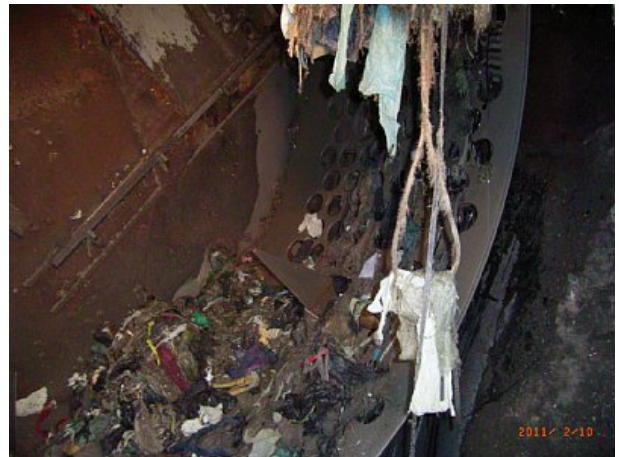
写真 F-4 前処理バイオリアクター内部(出口)
