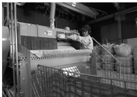
図 破碎機での破碎の様子
