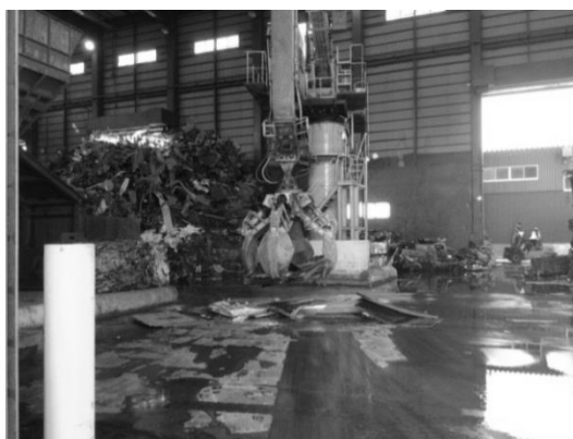
図 ローダーでシュレッダーに投入
