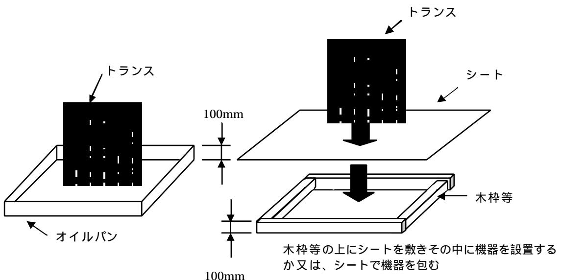
図 -3.2 オイルパン又はシートによる防護措置の例
