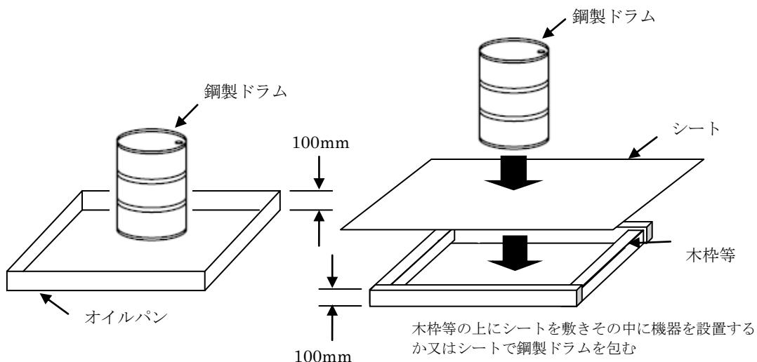
図III-1.3 オイルパン又はシートによる防護措置の例
