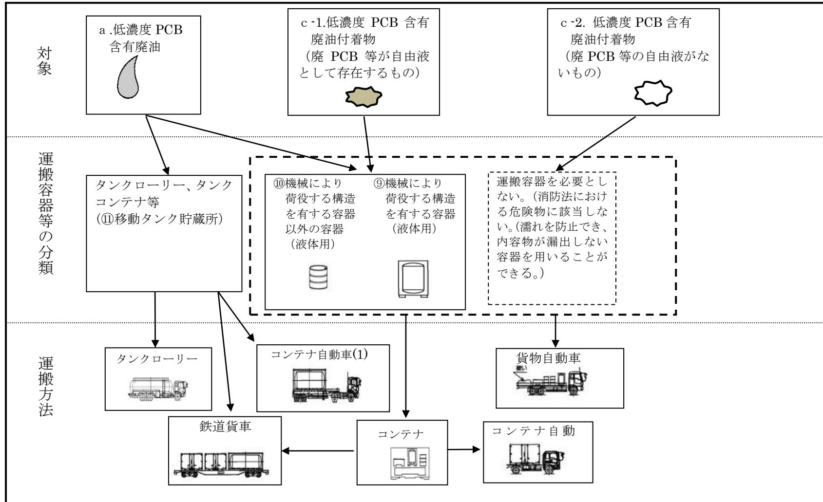
図III-1. 1 低濃度 PCB 含有廃棄物の運搬方法（運搬車による陸上運搬の例）
