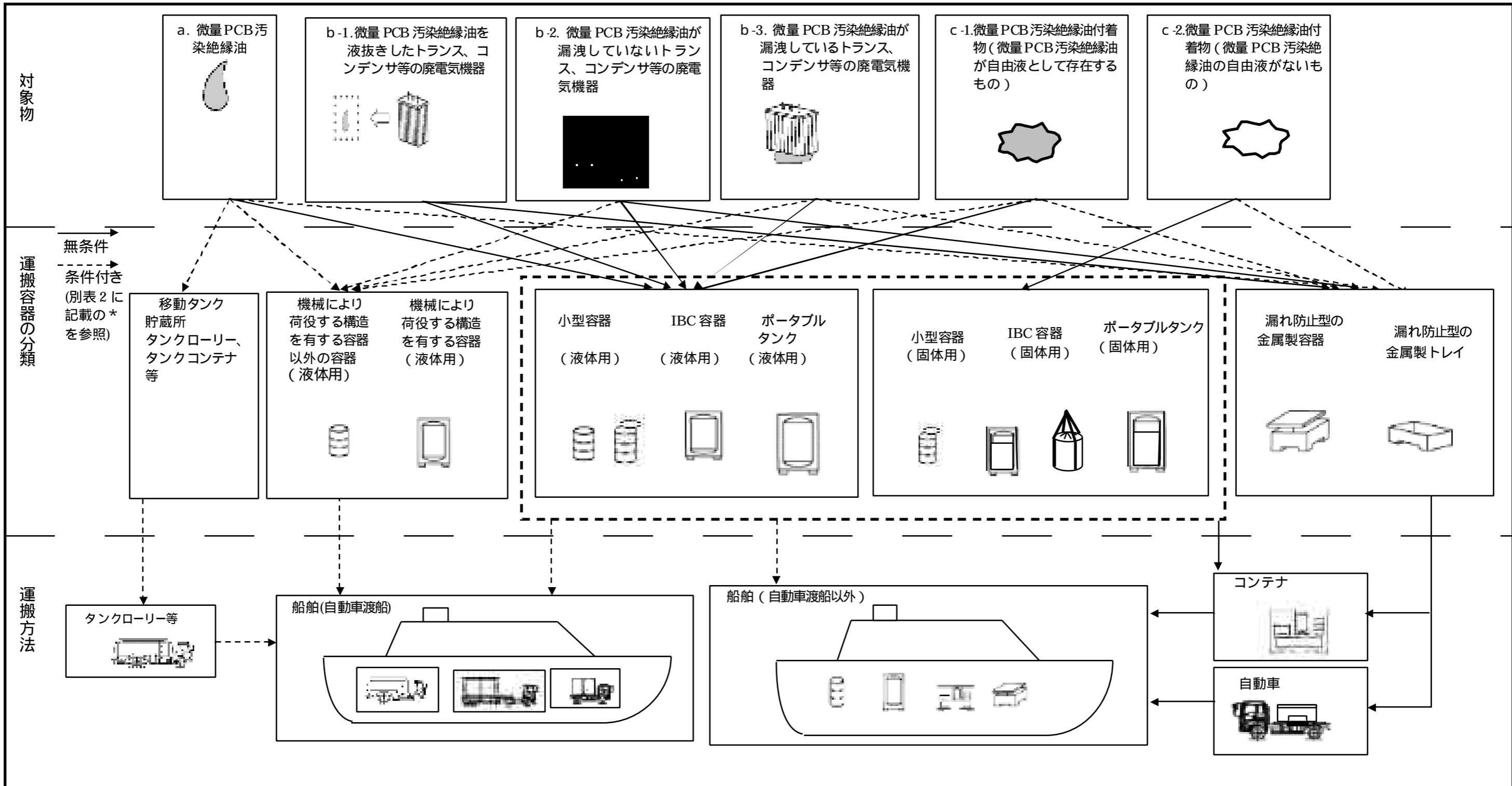
別図2 微量PCB汚染廃電気機器等の運搬方法(船舶による海上運搬の場合(PCB濃度50mg/kg超))
