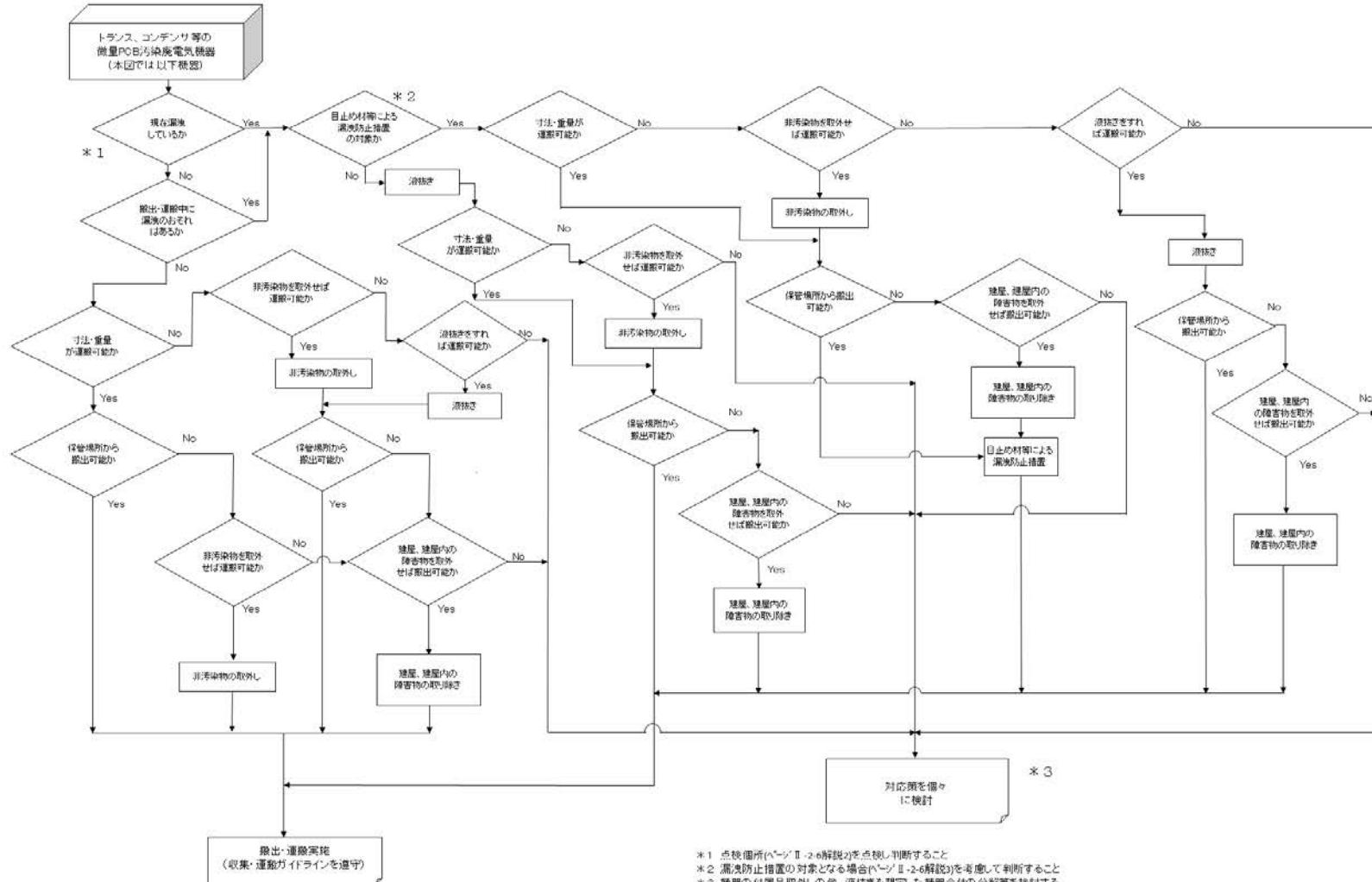
図 II-2.2 微量PCB汚染廃電気機器等の液抜き・解体の選定フロー
