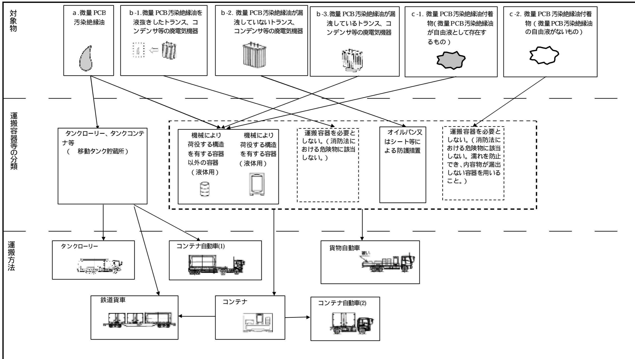
別図1 微量PCB汚染廃電気機器等の運搬方法(運搬車による陸上運搬の場合)
