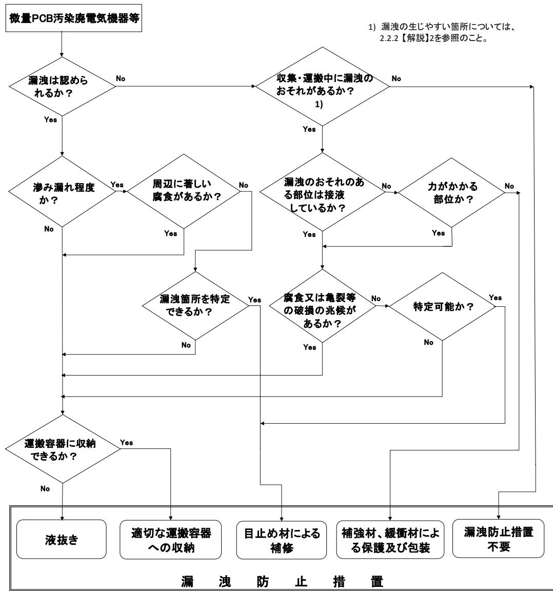
図 II-2.1 漏洩防止措置の選定フロー
