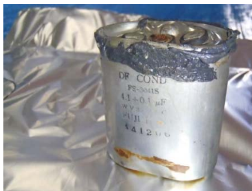
補修した剥き身コンデンサ（２）
