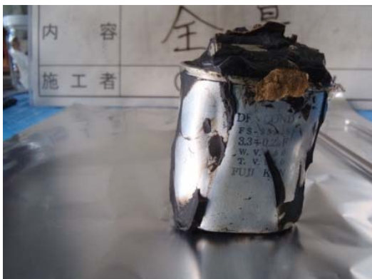
変形した剥き身コンデンサ（１）
