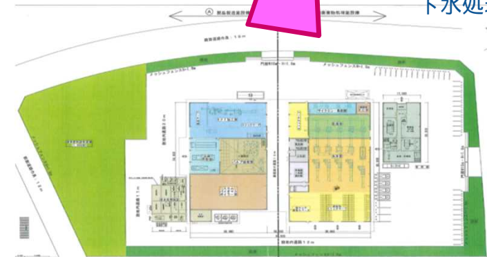
弊社モデル工場配置図 (使用済み紙おむつ20t/日処理)
