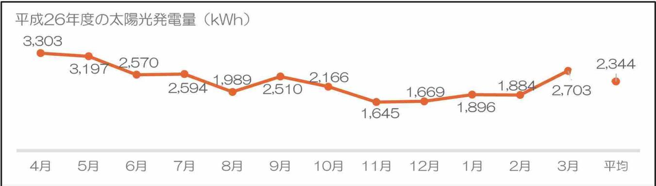
平成26年度の水処理施設の消費電力は約1,142千kWh、電気代は約2,300万円でした。平成26年度の太陽光発電(20kW)の発電量は約28千kWh(消費電力の2.46%)であり、年間約50万円の維持管理費用の負担が軽減されています。
