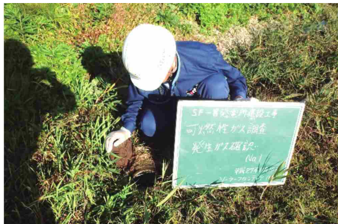
発生ガス確認の様子
