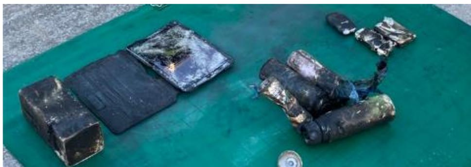
図 5-44 1月5日の火災の原因だと考えられるスプレー缶、リチウム蓄電池使用機器(埼玉県坂戸市)
