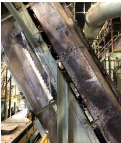
図 5-2 火災で焦げた破砕物コンベヤ
