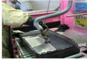
図4 塗布蛍光体の除去
