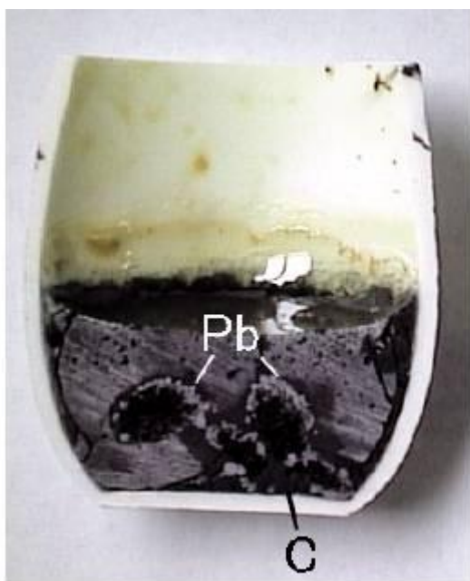
図10 ファンネルガラス粉末溶融後のガラス断面（一例）
