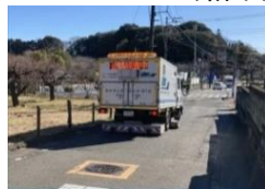
（空洞探査車による調査）
