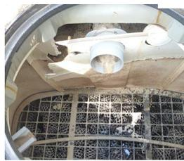
配管接合部の破損・本体の漏水
