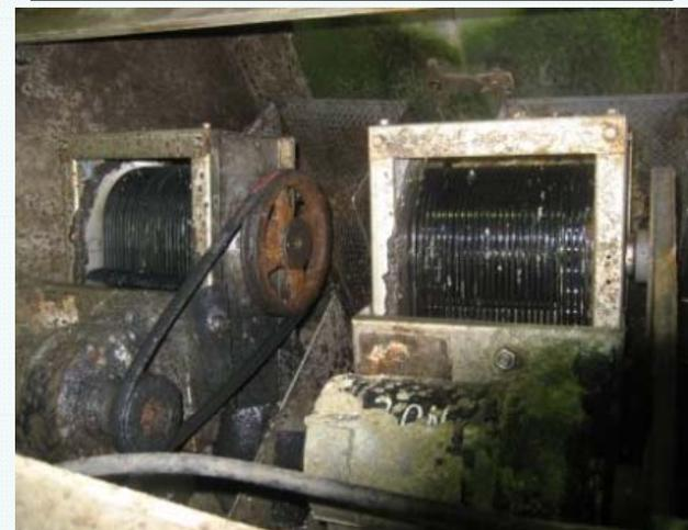
経年劣化により可動部にまで腐食が進行している
