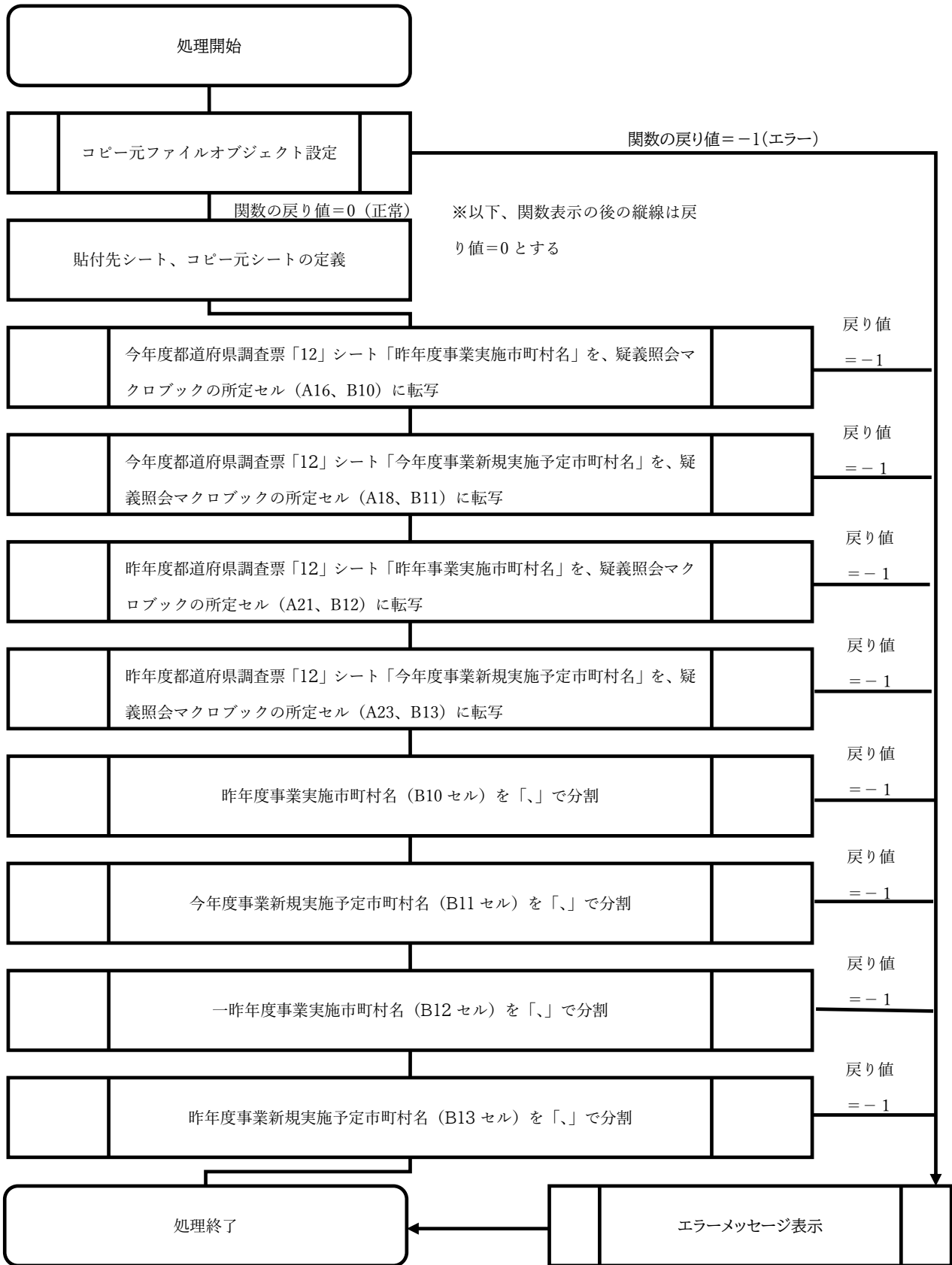
図 1-1 エラーチェック自動化ツールのフローチャート(No_12_Data_Copy 関数)
