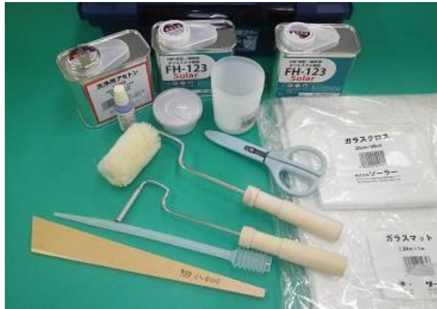
図1. 4 FRP成形・補修セットの例
