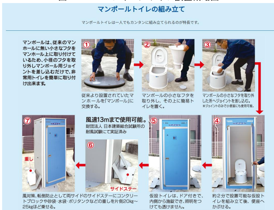
図2. 5 マンホールトイレ設置概略図
