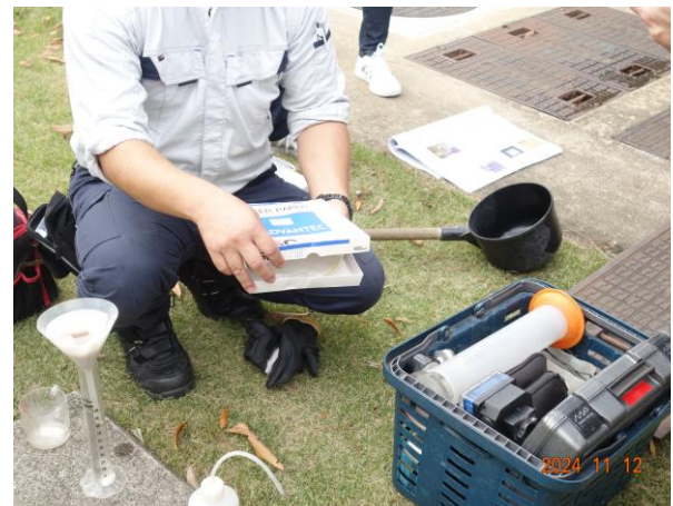
活性汚泥のろ紙濾過試験の様子
