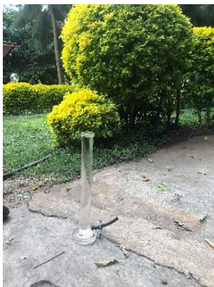
貯留槽水の透視度は 30cm 以上 (A 宅)
