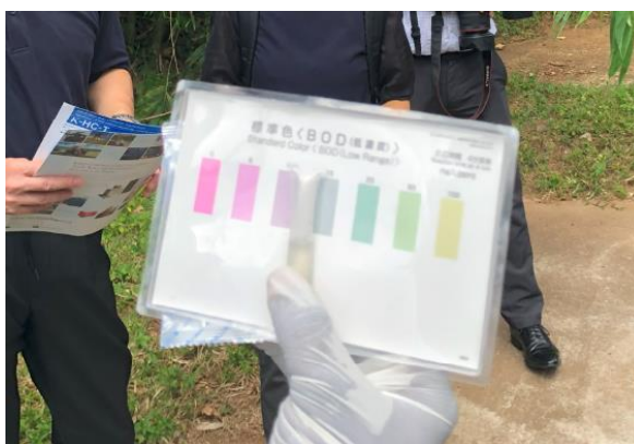
パックテストキットによる水質測定 (BOD 15 mg/L 以下)
