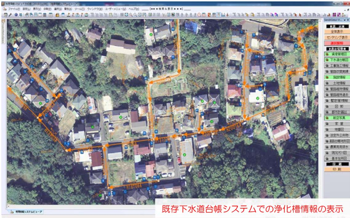
●仙台市下水道 GIS システムでの表示（下水道管渠施設と重ねて表示）
