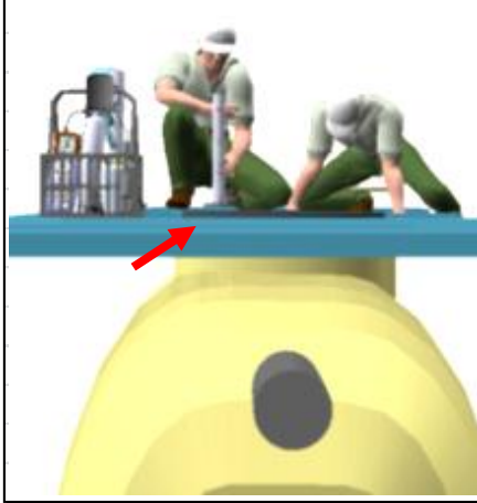
○歩廊と点検口の高さが同一
