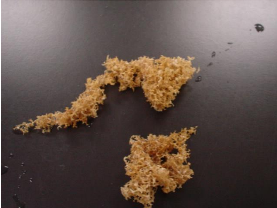
NO.19 加水分解して流出した担体。
