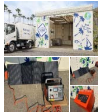
コンポストの空調補助にソーラーパネルを利用
