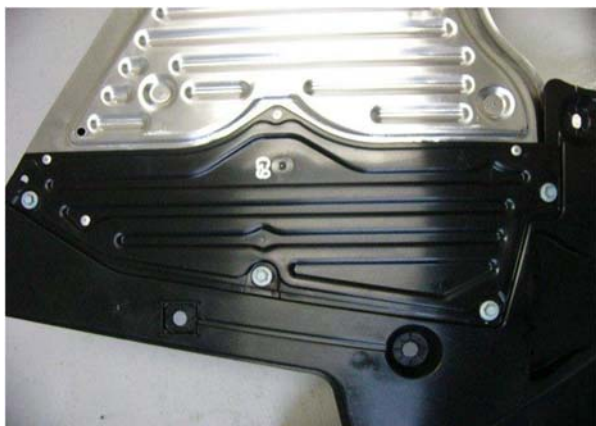
エンジンアンダーカバー (容リPPリッチペレット:50%使用)
