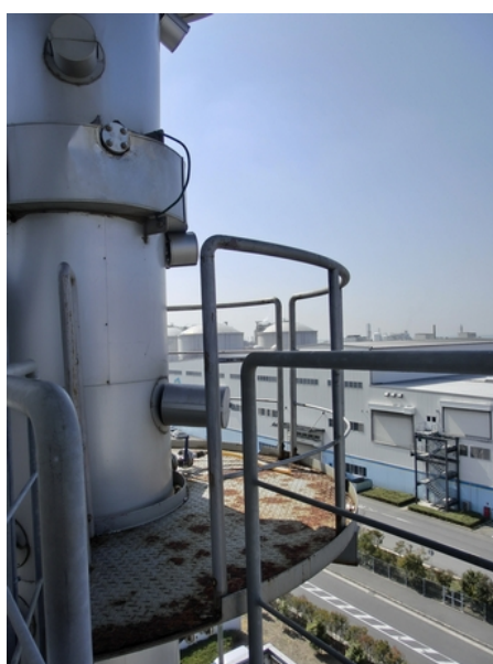
図 3-10 30%濃度バイオエタノール抽出用の抜出点（蒸留塔の 20 段目）
