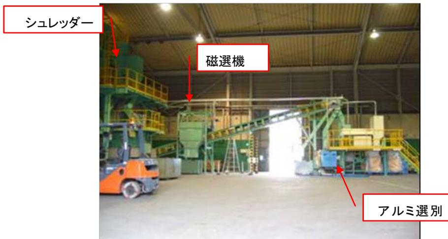
図 2-16 その他品目の機械処理ライン (写真)
