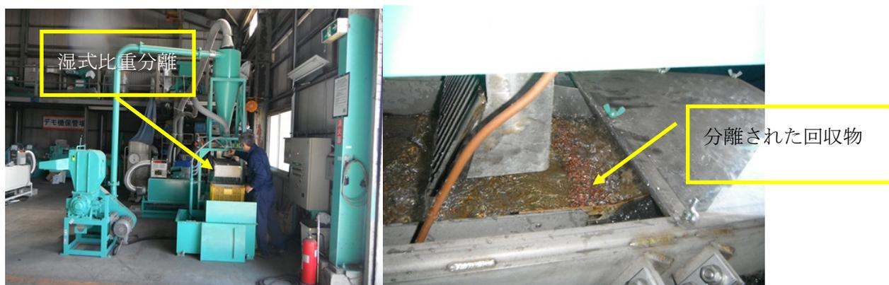
図 2-18 ナゲット機（湿式比重分離機）による銅選別
