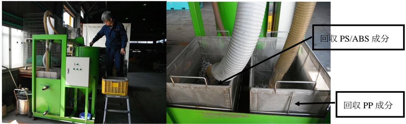
図 2-20 ハイドロサイクロン機（比重分離機）によるプラ選別
