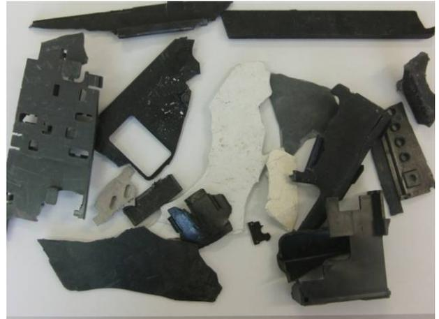
図 1-4 粗破砕されたミックスプラスチック(10mm~50mm 程度)
