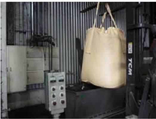
図.バイオマス炭を炭供給機に仕込み 1
