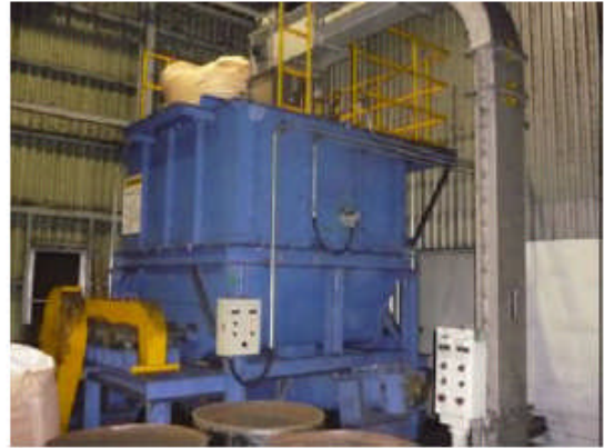
図.バイオマス炭供給機
