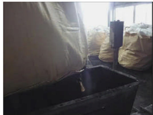
図.バイオマス炭を炭供給機に仕込み 2
