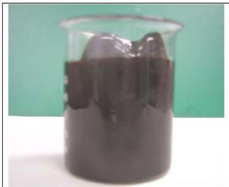
図 6-23 液体（スラリー）燃料の試作状況
