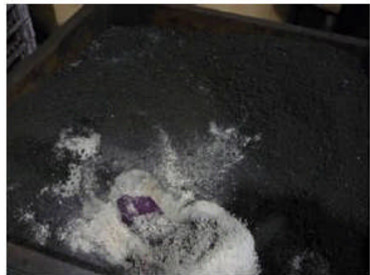
図.調湿を行わない場合の炭の発火 (白い部分は灰・赤い部分は燃えている)
