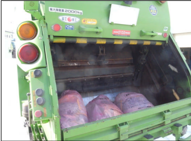
ルート回収 パッカー車での圧縮①
