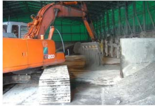
㊹スケルトンバケット付きユンボによる異物の除去。
