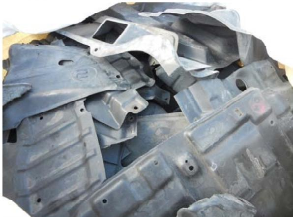
写真 36 エンジンアンダーカバー、スプラッシュシールド《PE》
