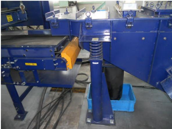
写真 21 振動篩機下から回収したハーネス(10mm↓)
