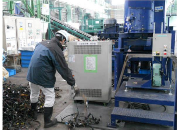
写真 18 振動篩機からのハーネス回収作業
