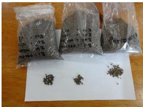
図 21. PT Petrokimia Gresik がバリクパパン市の資材を用いて試作したサンプル堆肥(写真左、中央)とペトロオーガニック(写真右)出所) 調査団撮影(2018年12月、於: PT Petrokimia Gresik)
