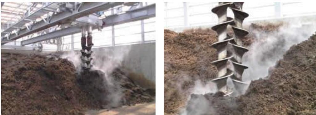
図 37. 天神製作所 TM 片懸垂式発酵攪拌機
