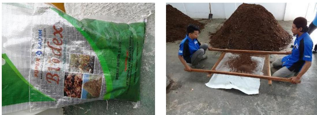
図 26. サンプル堆肥①試験の試験区 7、8 で用いた PI の生ごみ発酵促進剤 Biodex (左) と サンプリグ前に 4 mm メッシュ篩で異物を除去しているところ (右)
