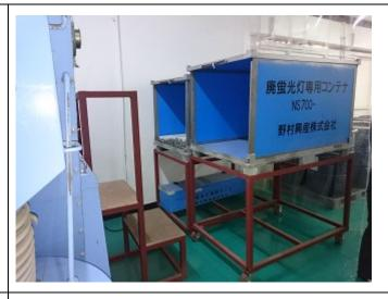
FRP社(2017年1月20日) 弊社が提供した蛍光灯回収ボックス。破砕作業効率を 考え、作業者が取り出しやすいよう独自に台を設置。 セブにも波及させたい。
