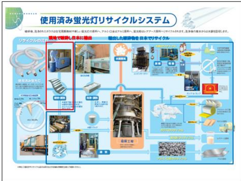
図 2-2 廃蛍光灯処理フロー
