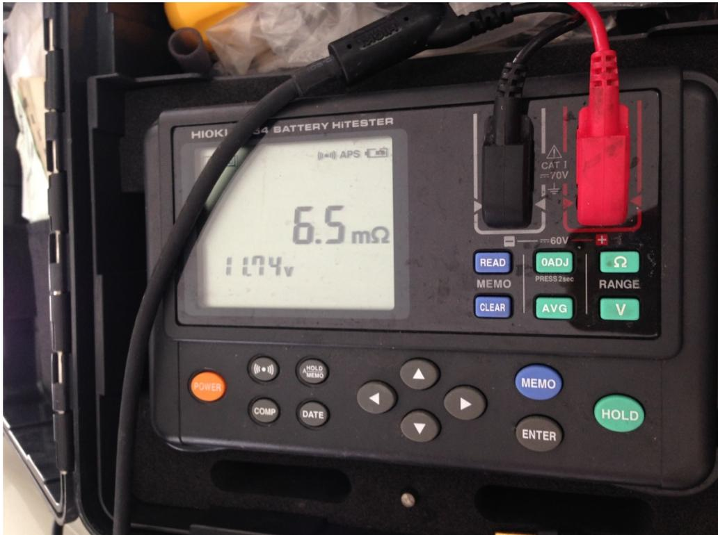
図 4-14 並行輸入車(エルブランド)の専用テスターチェック結果
