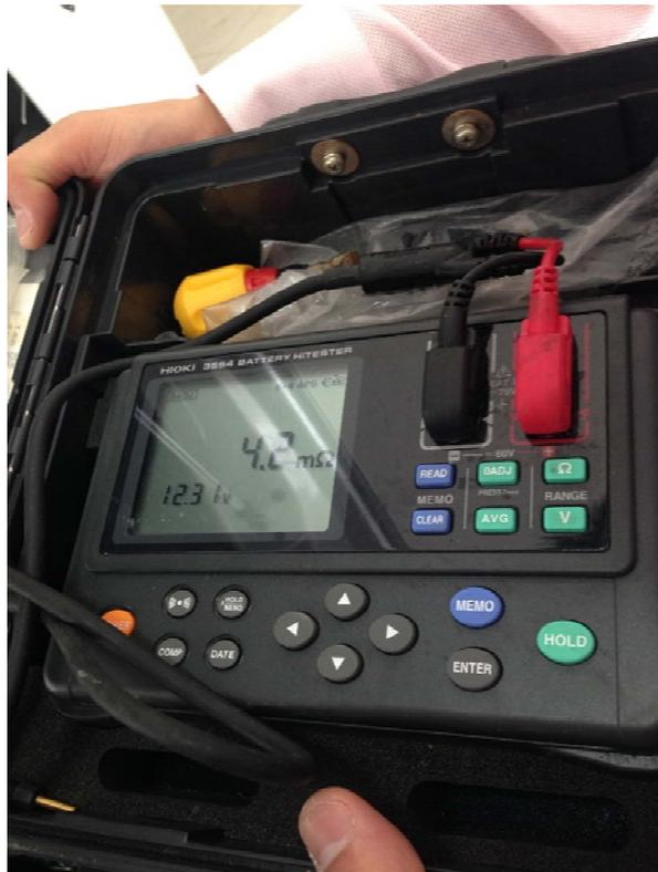
図 4-11 並行輸入車(ハリヤー)の専用テスターチェック結果
