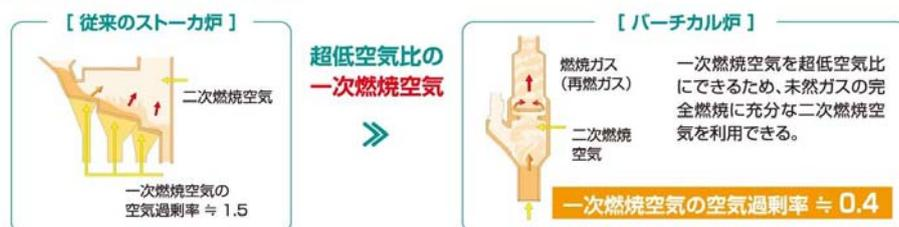
図3-2-2 SLA 燃焼方式の特長
