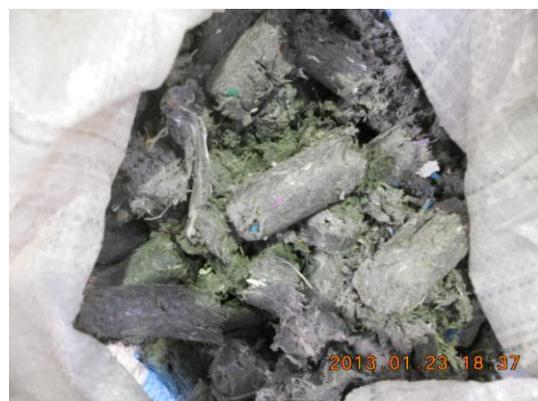
燃焼試験採用 RPF 製品
