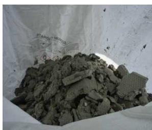
写真 排水処理汚泥
